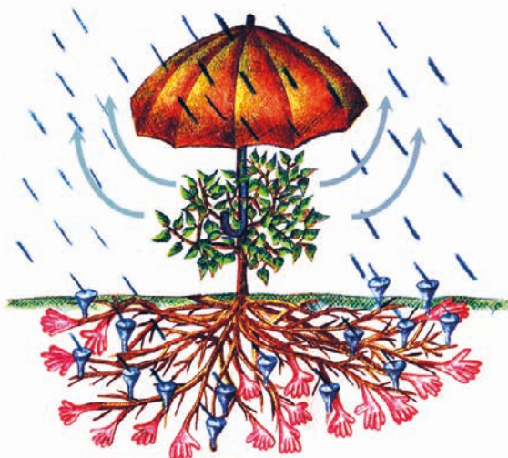
Abb. 1: Boden stabilisierende Pflanzenfunktionen: Interzeption, Evapo-Transpiration, Wasserspeichervermögen, Wurzelwirkungen.
