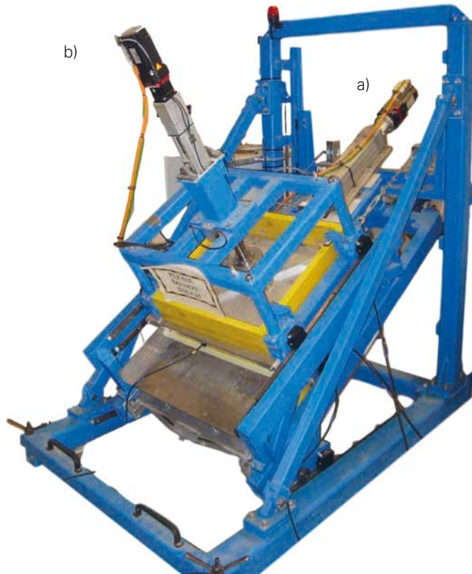
Abb. 11: Bis zu 45° neigbarer Direktscherapparat für grosse Proben von 50 x 50 x 40 cm mit Linear-Antrieben zum Aufbringen der Scher- (a) und Normalkraft (b).
