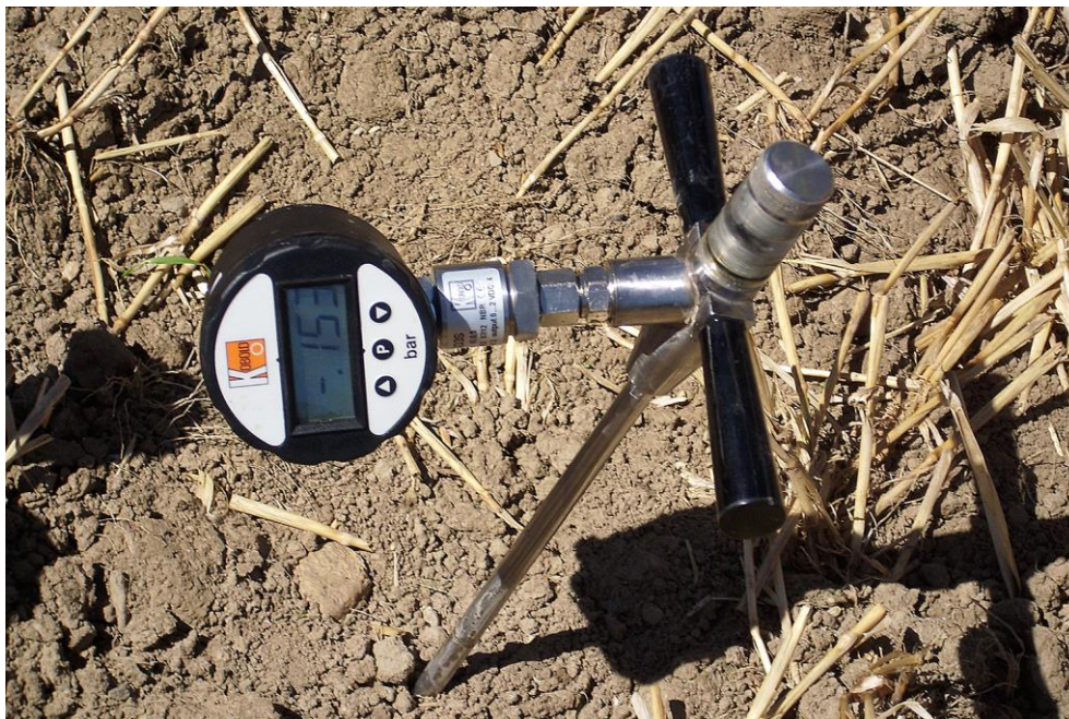
Abb. 24 > Messung mit schnell ansprechendem Tensiometer
